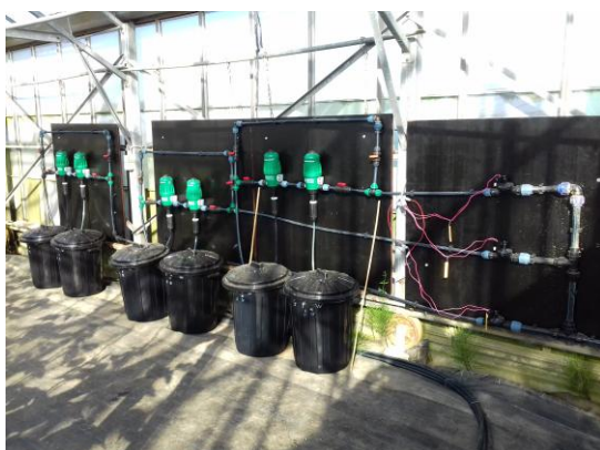
Figure 4 : Système de fertilisation avec pour chaque ligne un bac A et un bac B
