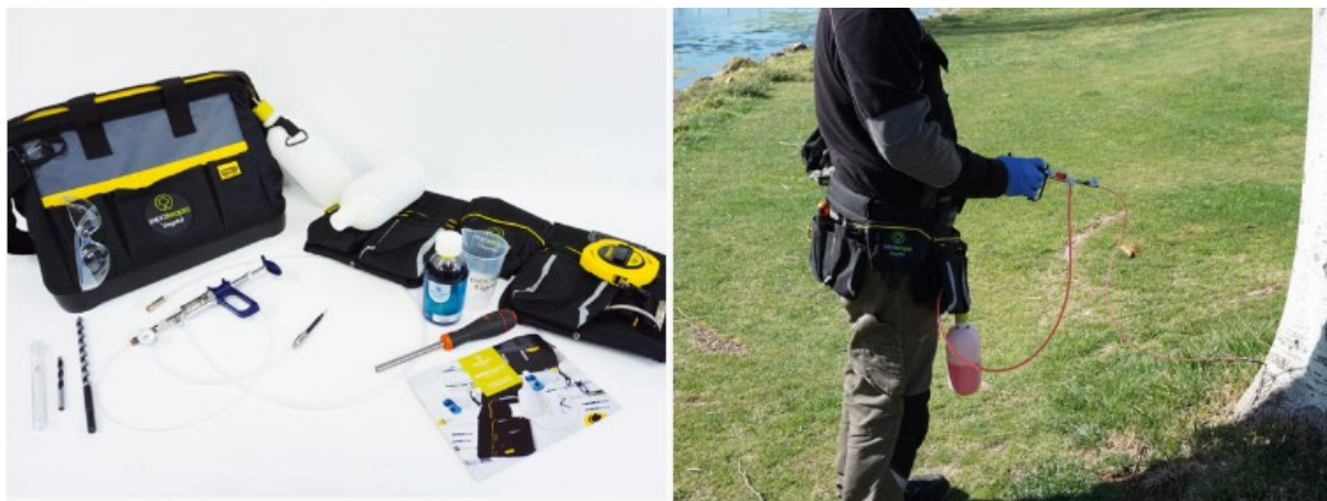
Figure 4: Dispositif d'injection ENDOTerapia Vegetal pour arbre adulte
