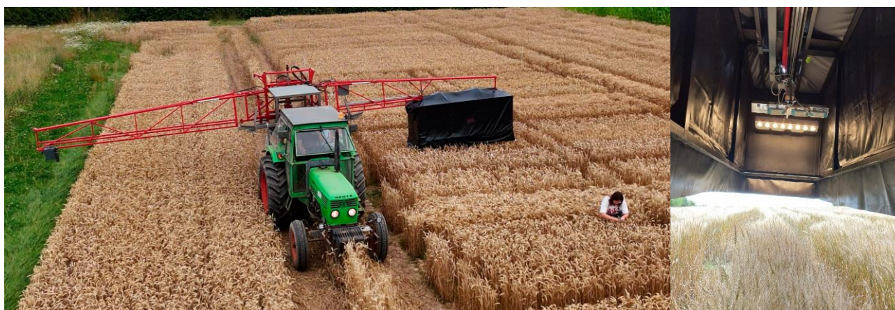
Figure 2 : Plateforme d'imagerie hyperspectrale embarquée sur tracteur et son système d'éclairage halogène.
